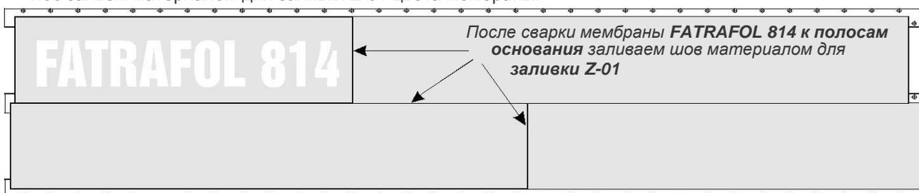
Монтаж полос можно реализовать так же, как стандартных видов мембраны боковым и передним переложением полос (см. гл.5.2.3.1). При этом способе укладки можно на поверхности изоляции легко заметить соединения полос, которые ухудшают общий внешний вид изоляции. Из-за местного утолщения изоляции в швах у поверхностей без наклона повышает-
