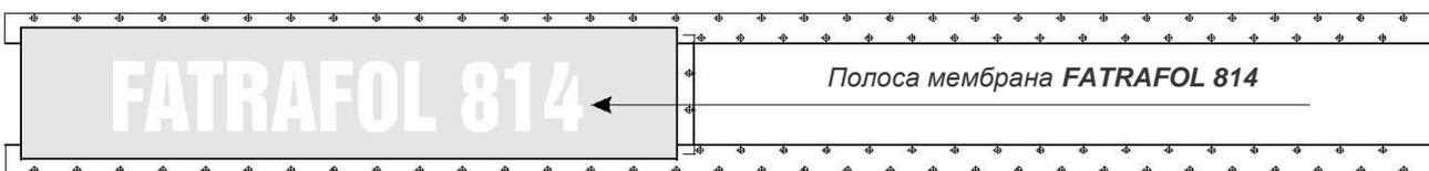
3. После покладки и сварки полосы по целому периметру положим следующую полосу мембраны FATRAFOL 814. Отдельные полосы положим на шов без боковых и передних припусков.
