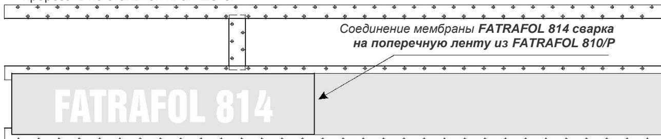
5. Процесс повторяем, когда целая поверхность заизолирована. На конец место соприкосновения двух полос зальём материалом для заливки Z-01 цвета мембраны.
